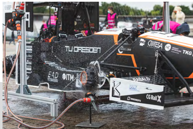
Checking the insulation of the electrical components in the Rain Test / Überprüfung der Isolierung der elektrischen Komponenten im Rain Test
