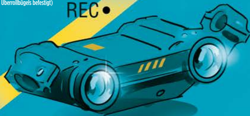
Inertial-Stereo-Camera-System (an der Oberseite des Überrollbügels befestigt)
