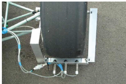
Measuring tyre temperatures Messung von Reifentemperaturen
