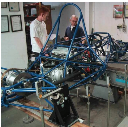
Testing a chassis for torsional stiffness Ermittlung der Torsionssteifigkeit einer Karosserie
