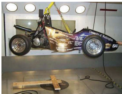
Measuring Polar Moment of Inertia Messen des polaren Trägheitsmoments
