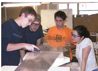
Students constructing a monocoque chassis Studenten beim Bau eines Monocoque-Chassis
