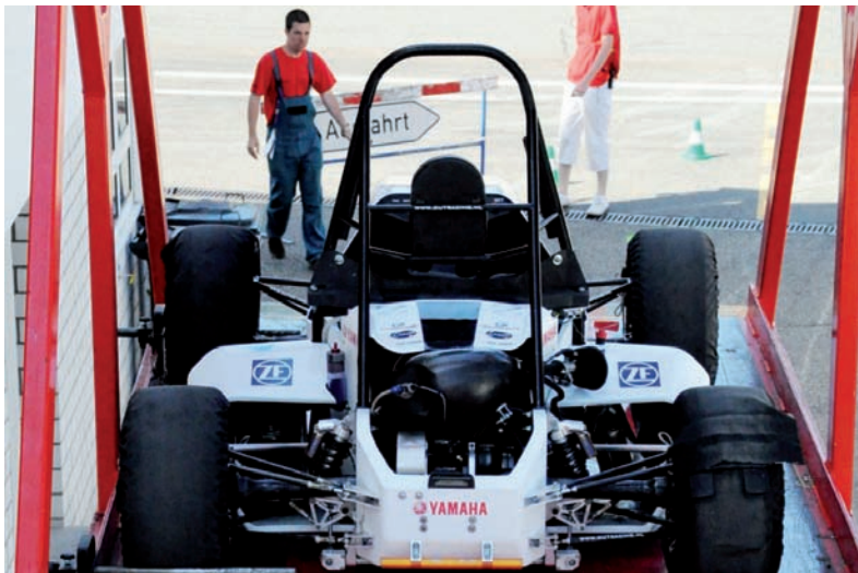
Rear assembly of engine and transmission of an FSC car using a one-cylinder engine. Heck eines FSC Fahrzeugs mit Einzylindermotor.
