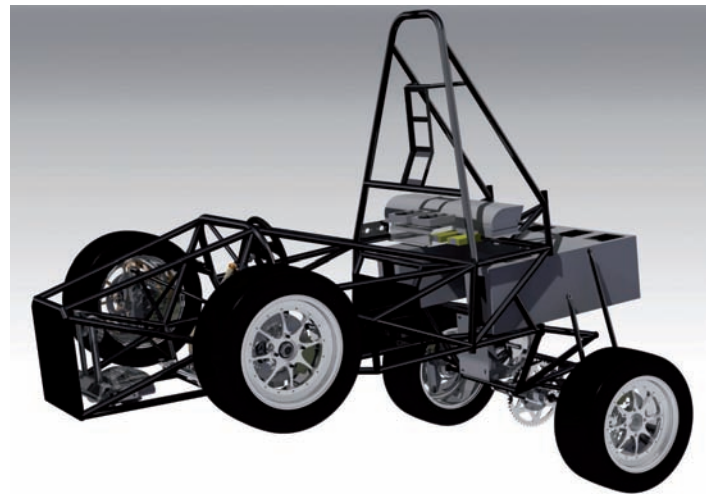
An FSE vehicle with an exchangeable battery system. Parts of the rear suspension and motor wires have to be disconnected to pivot subframe including motors, differential and rear suspension downwards to be able to remove the battery pack. Ein FSE Fahrzeug mit einem austauschbaren Batteriesystem. Zum Austausch müssen Teile des hinteren Fahrwerks sowie Motorkabel demontiert werden, um den Hilfsrahmen inklusive Motoren, Differential und Fahrwerk hinunterzuschwenken und so das Batteriesystem ausbauen zu können.
