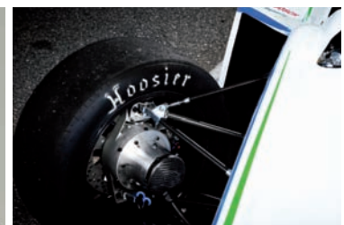
One of the wheel hub motors at the front axle. Einer der Radnabenmotoren an der Vorderachse.
