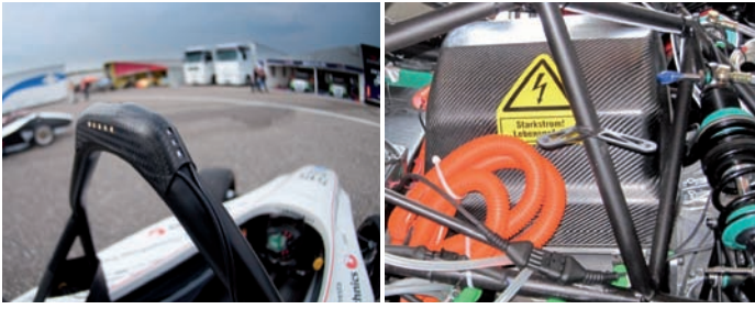
Safety measures: Tractive System Active Light on top of an FSE car (left) and high voltage sticker (right). Sicherheitsvorkehrungen: Hochspannungssystem Aktivlicht am höchsten Punkt eines FSE Fahrzeugs (links) und Hochspannungsaufkleber (rechts).
